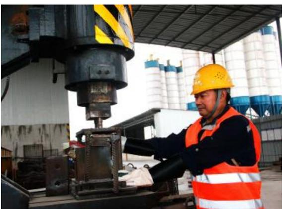
“质量月”活动开展以来,市政公司以精细施工过程管控为抓手,聚焦“品质铁建”,全面推进“提质增效、智慧建造”和“项目经理讲施组”“技术干部讲方案”工作,促进提品质、创品牌常态化,所属31个在建项目形成“崇尚工匠精神、质量一次成优”的良好氛围,市政、房建、水利和公路、铁路等多个工地被树为质量样板观摩点。图为该公司重庆铁路枢纽东环线项目一名工人正在用液压力冲孔机给角钢加工件冲孔。
